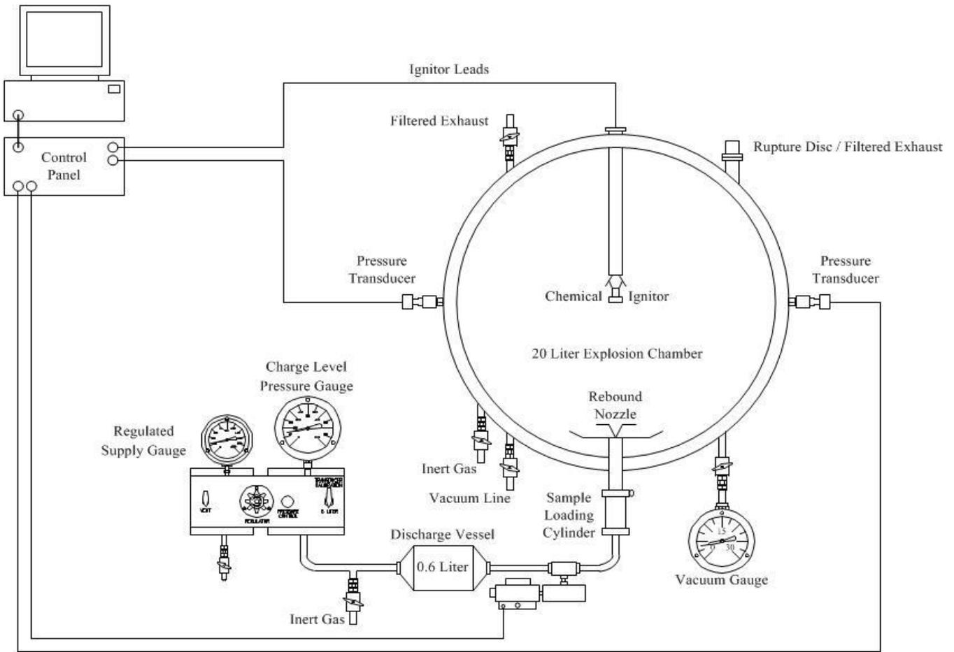
**Figure 2: 20 Liter Apparatus**
